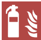
Fig. 8. Symbole de l'emplacement désigné de l'extincteur portatif.
